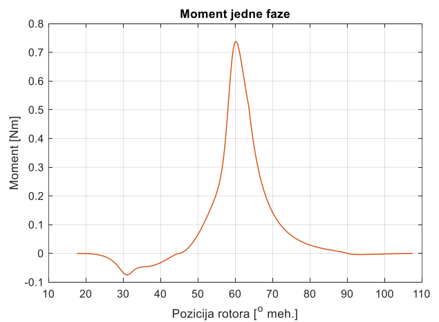
Slika 5.29 Talasni oblik momenta faze za brzinu 14000 ob/min
